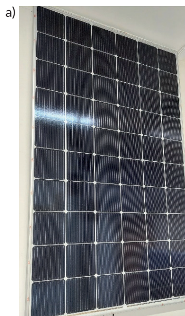
Rys. 3. Panele fotowoltaiczne wykonane technologiami: a) SmartWire; b) Bifacial, będące częścią wyposażenia stacjonarnego laboratorium fotowoltaicznego AGH w Miękinii
