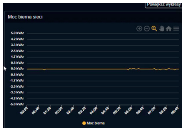
Rys. 5. Pobór mocy biernej sieci na kampusie Grupy Technologicznej Automatic Systems Engineering w ciągu dnia roboczego po zastosowaniu magazynu energii jako urządzenia kompensującego
